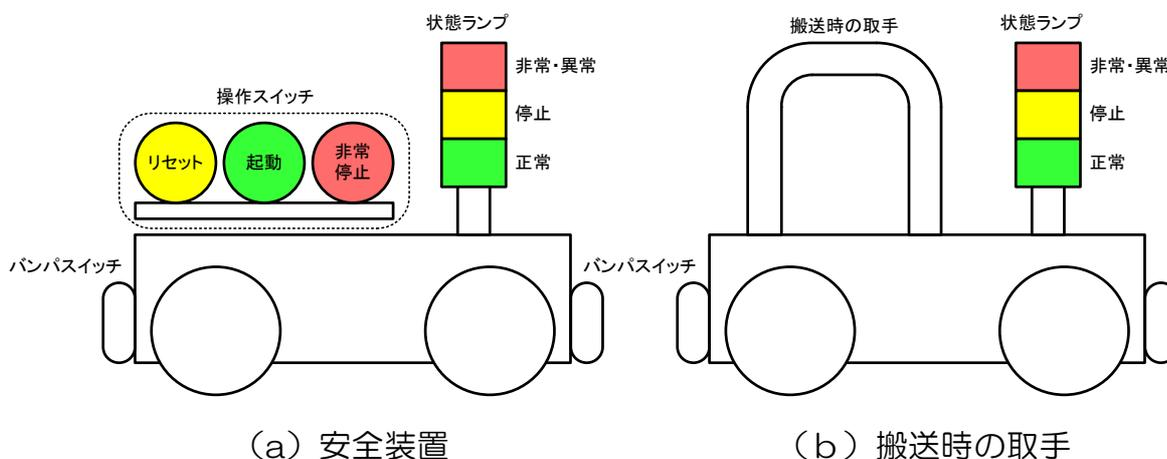
図2 競技に使用するロボットの構成図
