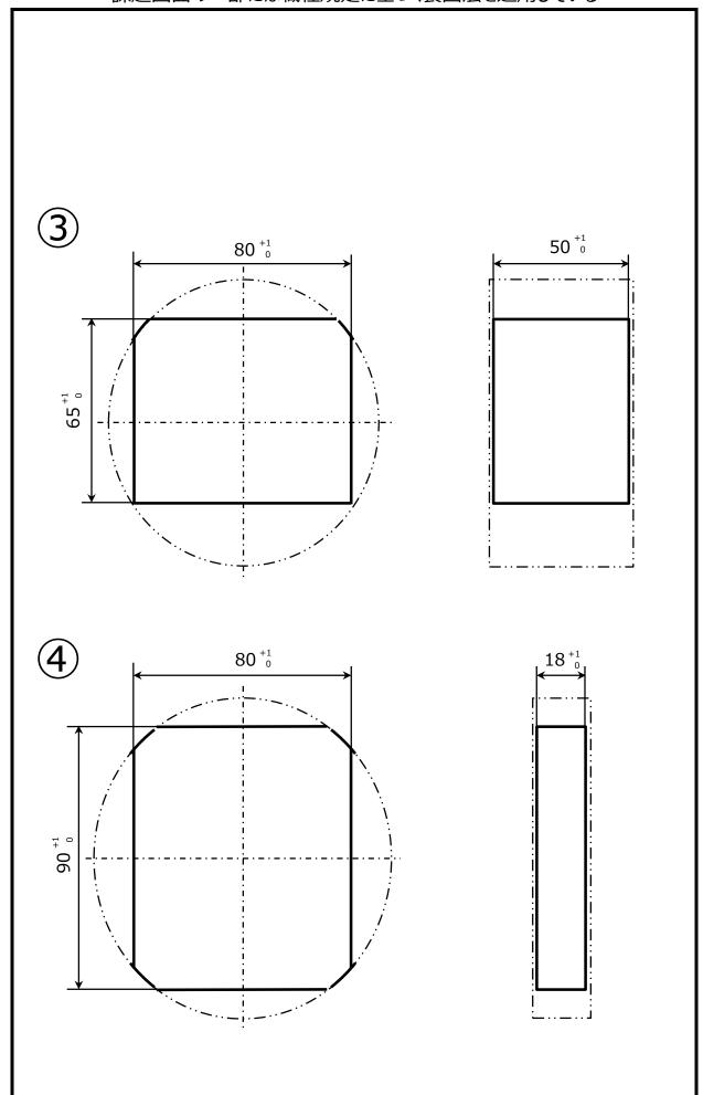
第57回 技能五輪全国大会フライス盤職種試し削り図面(2/2)
