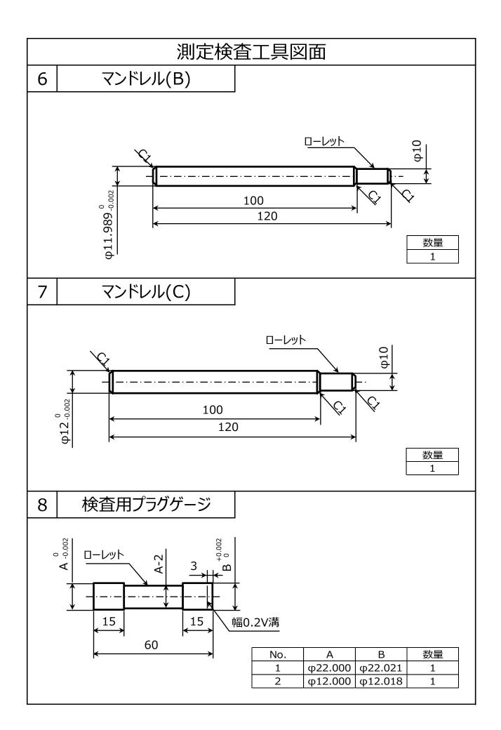
第57回 技能五輪全国大会フライス盤職種測定検査工具 (3/5)
