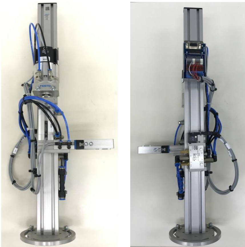
図3 ロータリ・リフティングモジュールの持ち込み状態
