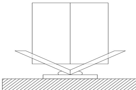
4. 溶接番号①の溶接終了後、全部品の組立を行う。組立順序については自由とする。全部品の組立終了後、溶接を行う。溶接については作業台の上に材料符号Ⓐを置き、定められた溶接姿勢で行う。また、作業台とⒶの間に支え物を入れてはいけない。
