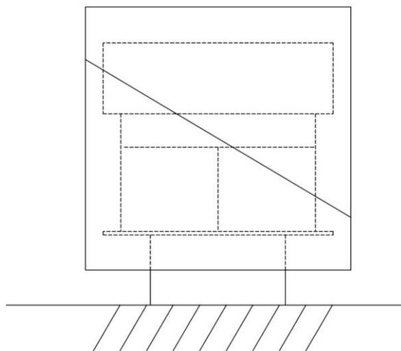
6. 溶接番号① ③以外の溶接については作業台の上に材料符号Ⓐを置き、定められた溶接姿勢で行う。又、作業台とⒶの間に支え物を入れてはいけない。
