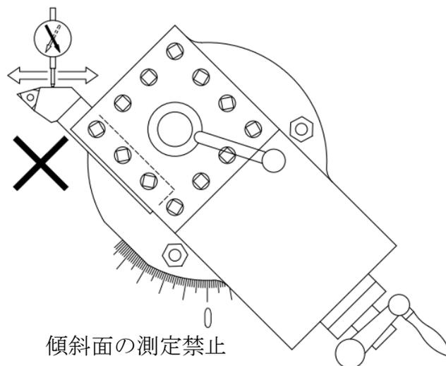
図 15 固有の傾斜面測定禁止
