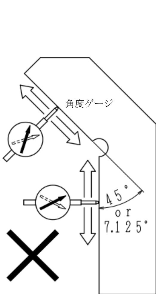
図9 許可されない専用角度ゲージ
