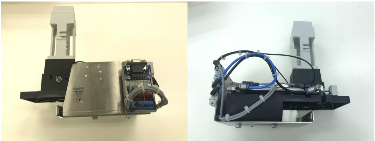
図3 マガジンモジュール持ち込み状態
