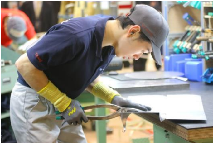
鋼板の切断作業（上三川町・日産自動車栃木工場体育館）
