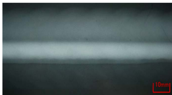
図8 X線透過試験フィルム(湿度約 50%)
