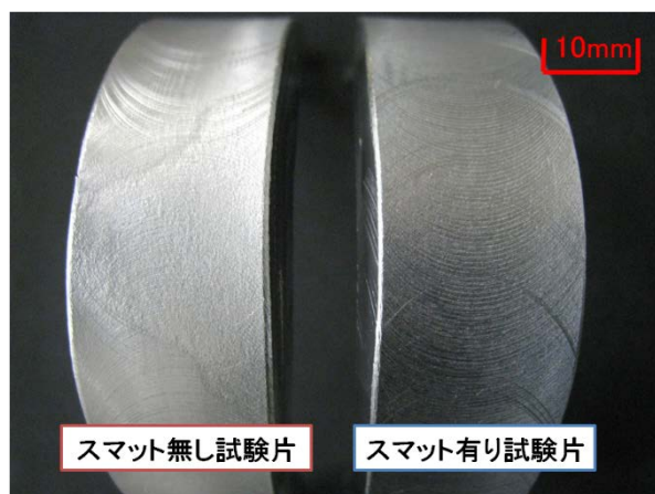
図6 曲げ試験結果の例
