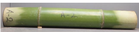
(d) 天然乾燥処理だけで 56 日間屋外暴露されたモウソウチク試験体 (A-2)
