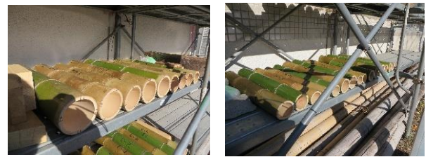
図 3 屋外暴露 11 日後のモウソウチク試験体
