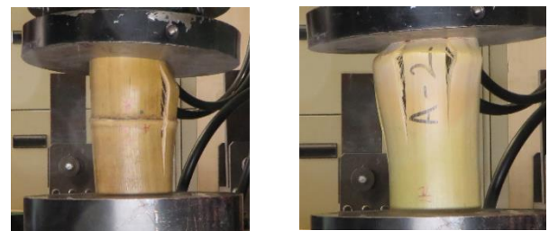
(a)人工乾燥処理 (節有) (b)天然乾燥処理 (節無)
