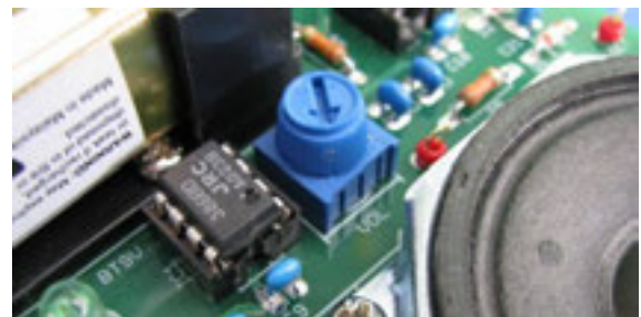
図 11 スピーカ音量調整用の手回し可変抵抗
