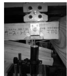
図16 新形状蟻仕口、女木材成180 mm、腰成60 mmの場合の割裂破壊の様子
