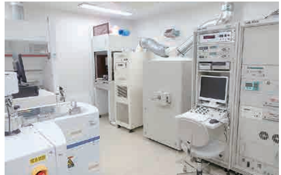
クリーンルーム ／ほこりの侵入を防ぎ、空気清浄度が一定に保たれた実験室です。電子線描画装置などを用いて0.1μm単位の微細加工が可能で、ホログラムの作製などに使用されています。
