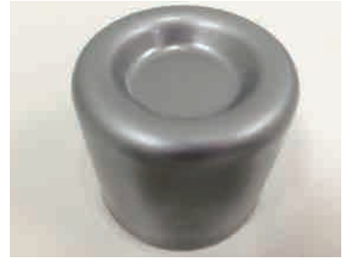
対向液圧プレスを利用した逆再絞り法による深絞り成形品(銅板)
