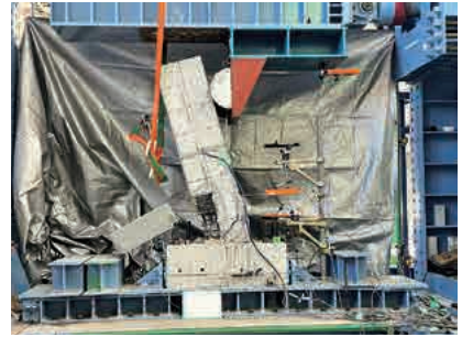
鉄筋コンクリート柱の解体実験の様子
