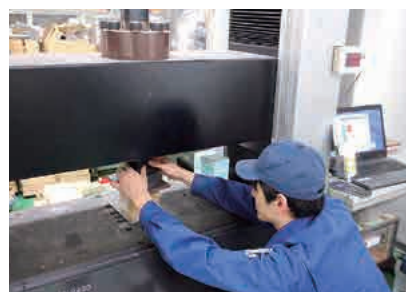
材料試験機を用いた木材の性能を確かめる実験
