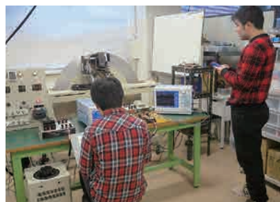
回転円盤式リニアモータを用いた制御実験
